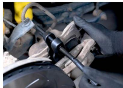
NOTA: Diseñado para hasta 6 pinzas de freno de pistón (según el tamaño / grosor de la pinza)
