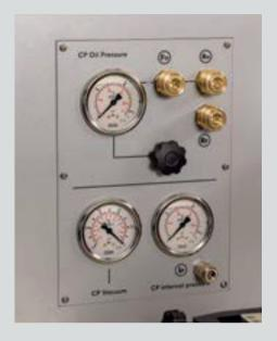
Baja presión de suministro/rendimiento de succiónMide la presión de entrada producida por la bomba de suministro o el vacío producido por la propia bomba. Información de diagnóstico importante para muchos tipos de bombas e incluso para las bombas de la última generación EU6 [CRp-iP3 KIT]6
